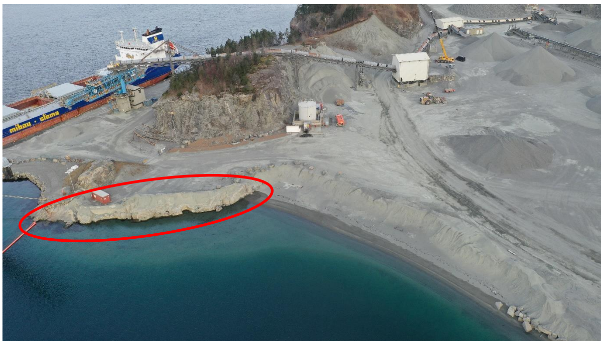
Figur 6. Et av områdene i deponiet hvor det trolig foregår stor utvasking og spredning av partikler. Område innenfor rød avgrensning er det samme som er avmerket i figur 5.
