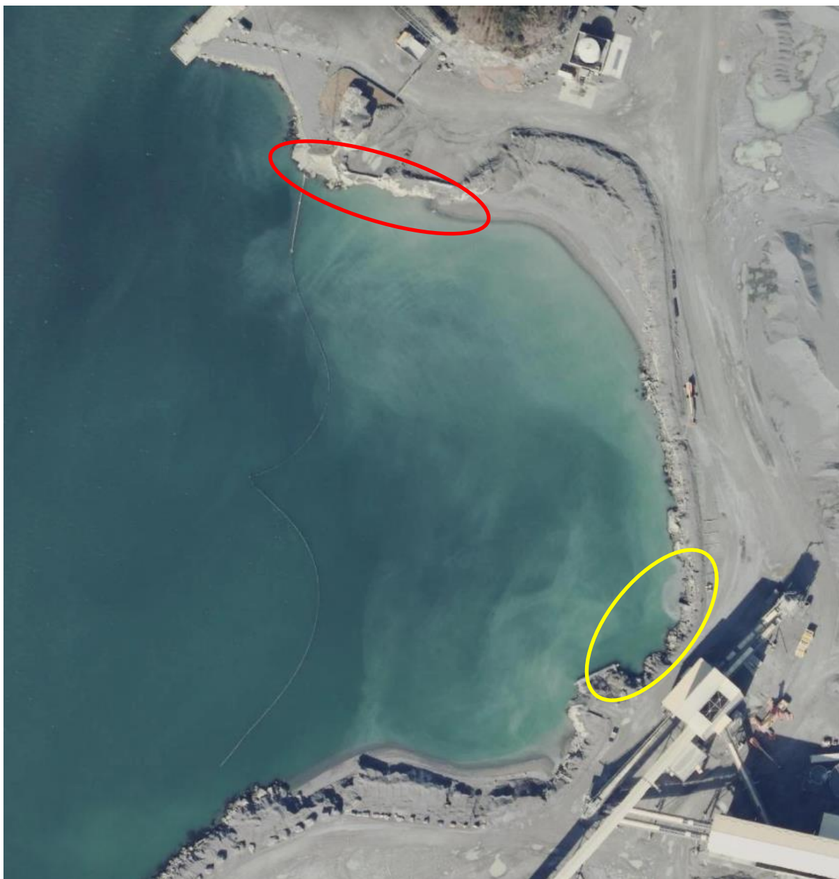
Figur 5. Flyfoto fra 2020 som viser partikkelspredning fra grunnområdene av deponiet. Rød sirkel indikerer område hvor det tilsynelatende foregår stor utvasking og spredning.
